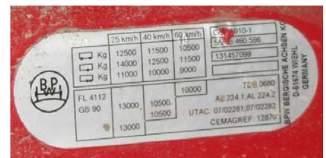
Achstypenschild: Tragkraft bei 40 km/h und Tandemachse = 10'000 kg Bremsen FL 4112: Bremstrommel 410 x 120 mm
