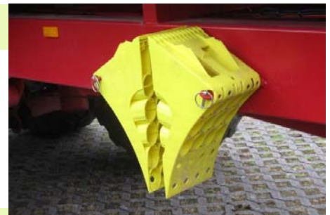
Radkeile gut zugänglich angebracht.
